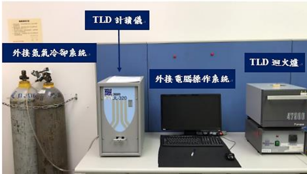
圖 3-10、TLD之計讀設備，其包含了TLD計讀儀本身、外接電腦操作系統以及外接氮氣冷卻系統。
