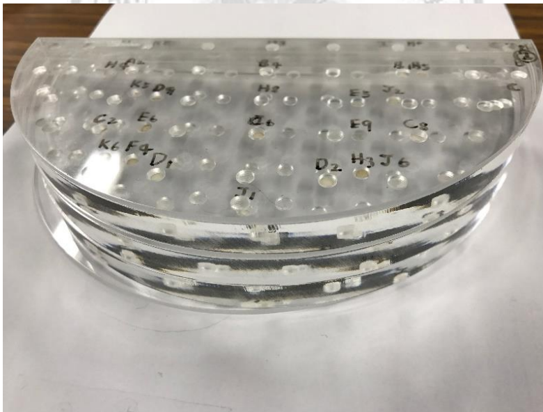
圖 3-8、三層壓克力假體，單層置放8顆TLD，TLD交錯排列。
